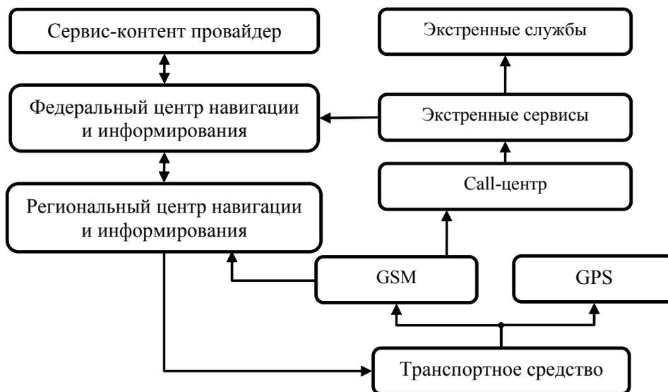
Рис. 5. Архитектура системы «ЭРА ГЛОНАСС»
