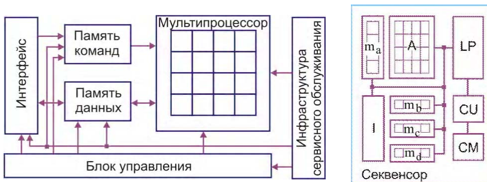
Рис. 7. Архитектура ЛАМП и структура УПУ
