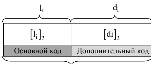
Рис. 3. Структура кода низкочастотной компоненты
