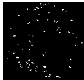
Рис. 8. Видеоизображение подложки GaAs диаметром 4 1/2 марки АГЧХ ориентации (100) Рис. 9. Изображение после порогового преобразования Рис. 10. Фильтрованное изображение
