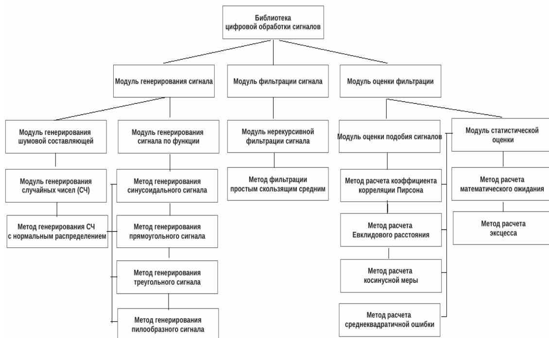
Рис. 1. Структура созданной библиотеки для цифровой обработки сигналов
