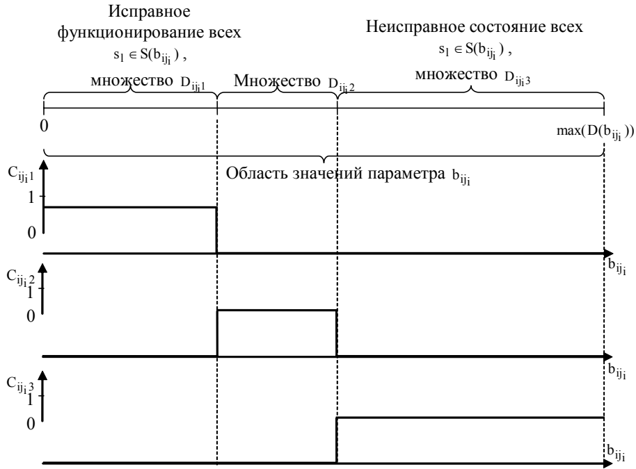
Рис. 1. Пример задания функций c_{ij;k_{ij}}(b_{ij}) , K_{ij} = 3 , на множестве значений D(b_{ij}) параметра b_{ij} ИДИ a_i
