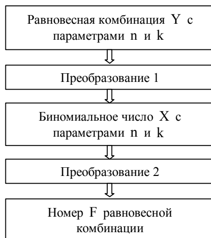
Рис. 1. Общий алгоритм биномиального нумерационного кодирования
