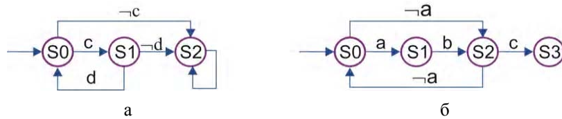
Рис. 2. Реализация глобальных LTL-операторов в виде автоматов
