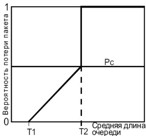
Рис. 4. Зависимость вероятности потери пакета для разной средней длины очереди
