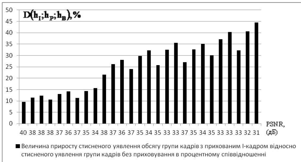
Рис. 3. Діаграма приросту D(h_I; h_P; h_B) стисненого представлення обсягу групи кадрів з прихованим I-кадром відносно стисненого представлення обсягу групи кадрів без приховування в процентному співвідношенні з урахуванням середніх значень пікового відношення сигнал/шум для середньонасичених зображень
