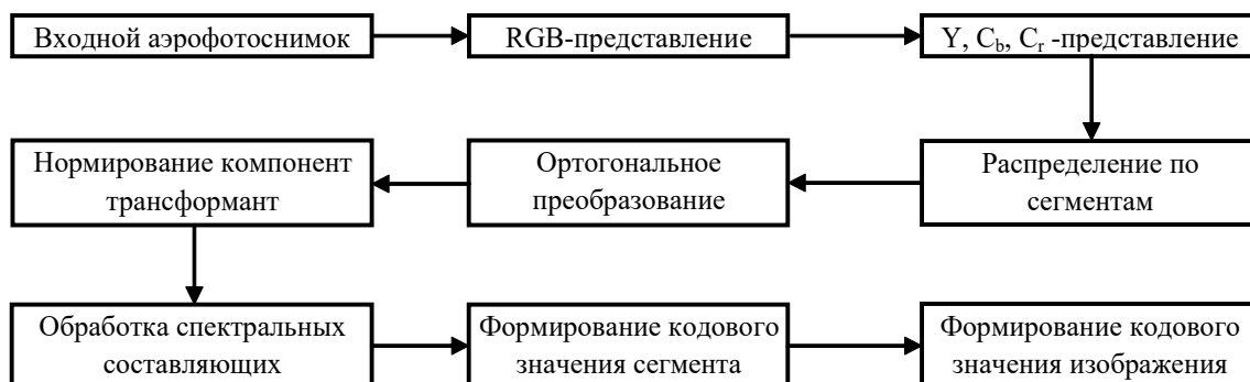
Рис. 1. Схема базовой технологии эффективного кодирования с применением предварительного трансформирования и последующего нормирования
