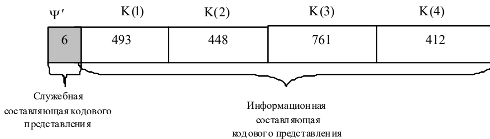
Рис. 3. Кодовое представление фрагмента F, полученное в результате косвенного стеганографического встраивания
