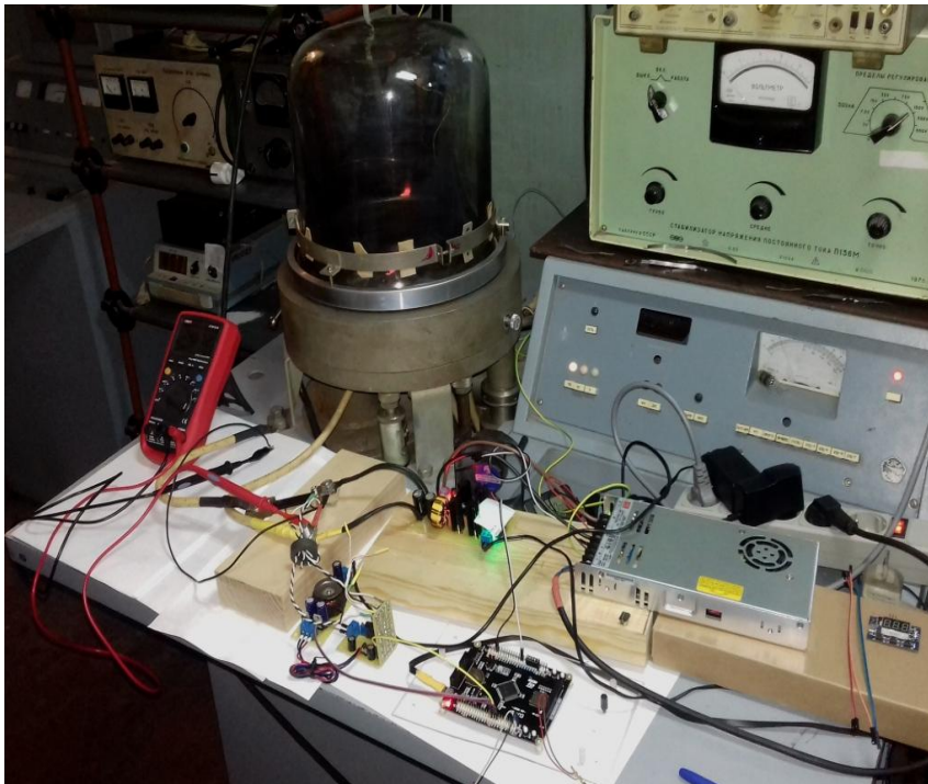
Рис. 12. Система керування нагрівачем в вакуумі
