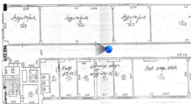
Рис. 4. Реализация метода локализации объектов с использованием iBeacon для устройств на базе ОС IOS
