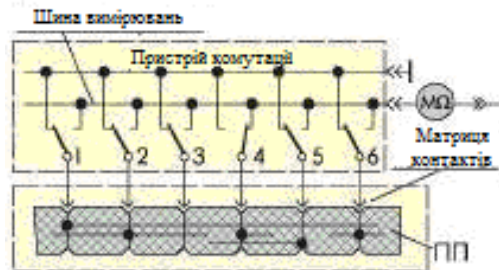
Рис. 2. Принцип комутації ланцюгів в тестерах з матрицею контактів
