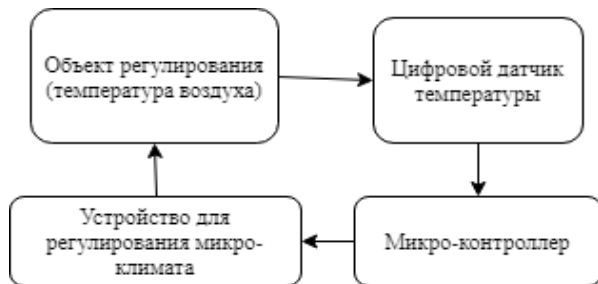
Рис. 2. Структурная схема для регуляции температуры
