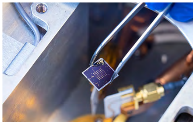
Рис. 1. Решітка сегнетоелектричного матеріалу для реалізації транзистора і пам'яті
